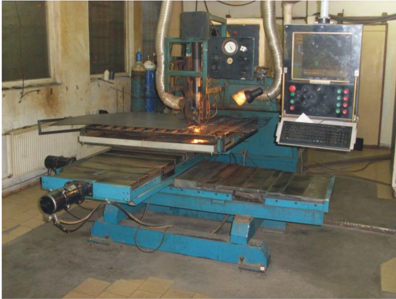
Технологична система за лазерно рязане с бързопроточен CO2 лазер и двукоординатна маса
