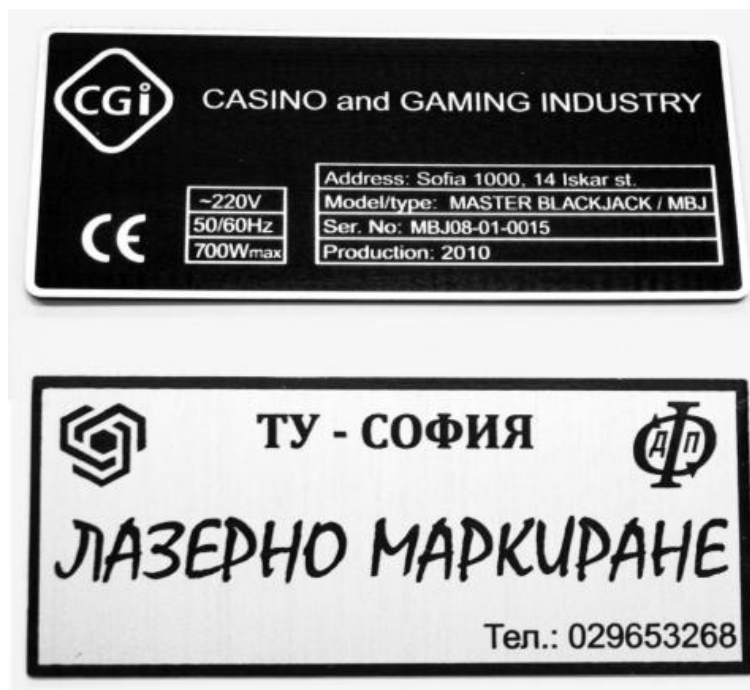
Лазерно маркиране чрез аблация (горе) и бондиране (долу)
