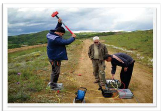
Фиг. 12. Възбуждане на сеизмични вълни посредством удар с чук (ляво); синхронизация на група вибратори (дясно).
