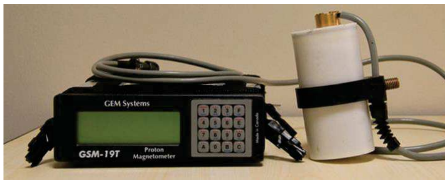
Фиг. 6. Магнитометър GSM-19T на фирма GEM Systems, Inc.
