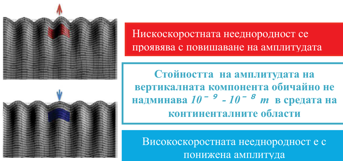
Фиг. 1. Модел на взаимодействието на локалните нееднородности с фундаменталната мода на вълната на Релей (двумерен)
