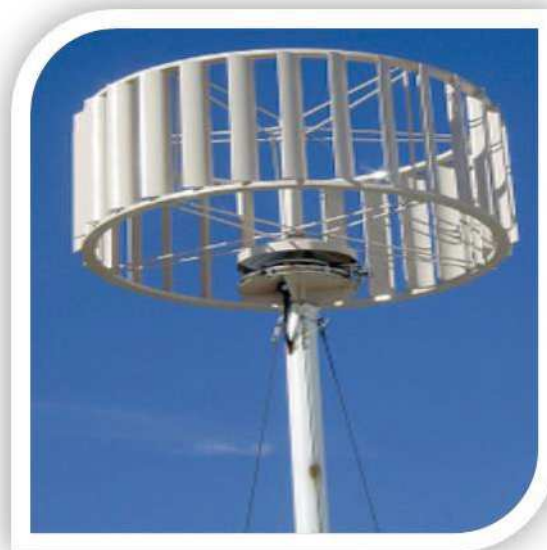
Фиг. 3. Ветрогенератори с ротори с комбинирано действие.
