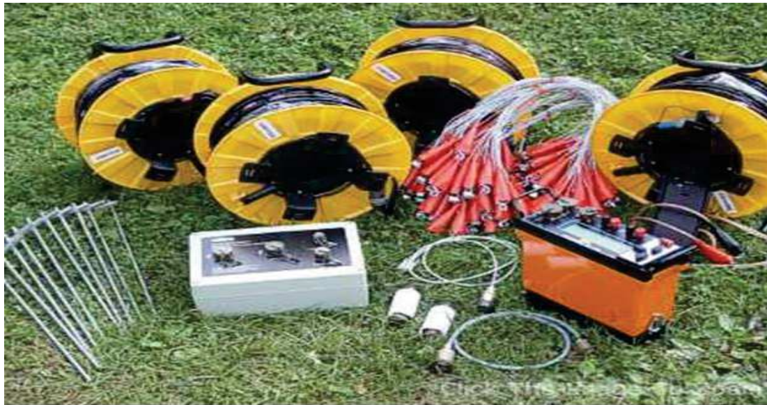
Фиг. 1. Снимка на измервателната апаратура и техническото оборудване, използвани при електросъпротивителни измервания.
