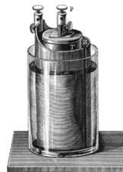
Фиг. 3. Схема на клетка на Гроув.
