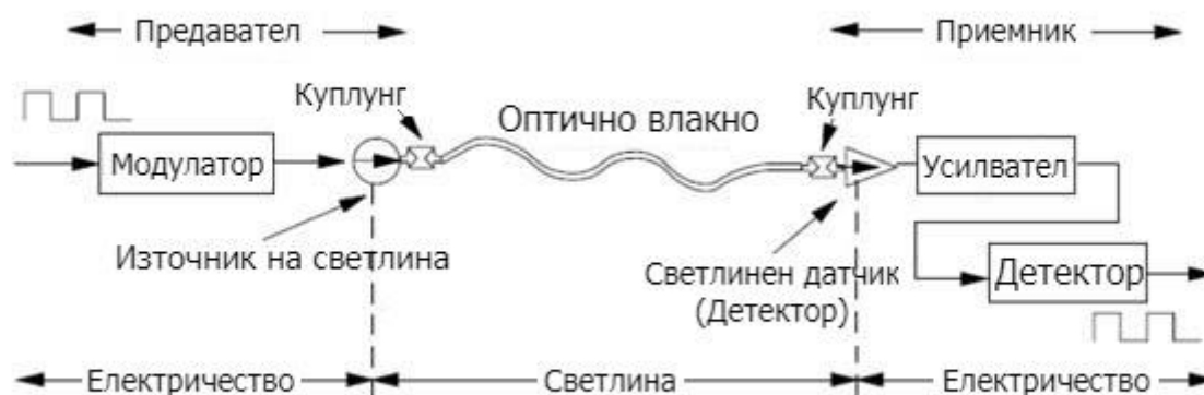
Фиг. 1. Принцип на действие на оптична система
