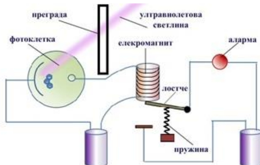
Фиг. 5. Принцип на действие на алармена система, реализирана на фотоелектричен принцип
