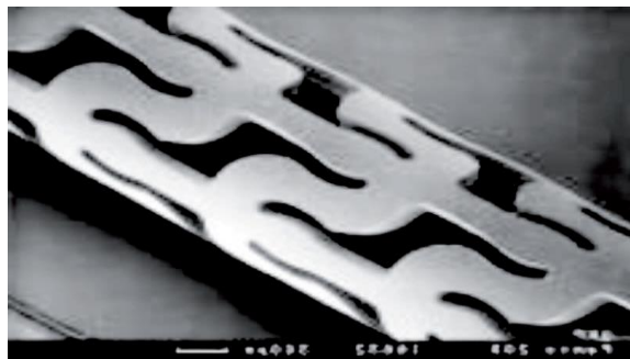
Фиг. 8. Коронарен стент изработен от биосъвместим полимер без постпроцесинг
