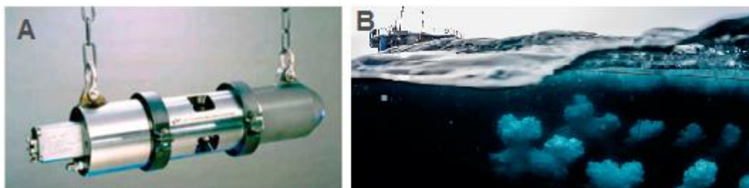
Фиг. 2. Източник на акустични вълни в морски сеизмични изследвания: А – мостра; В - в процес на работа
