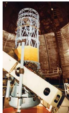
Фиг. 4. 2.5 м телескоп в Обсерваторията Mount Wilson, използван от Е. Хъбъл.
