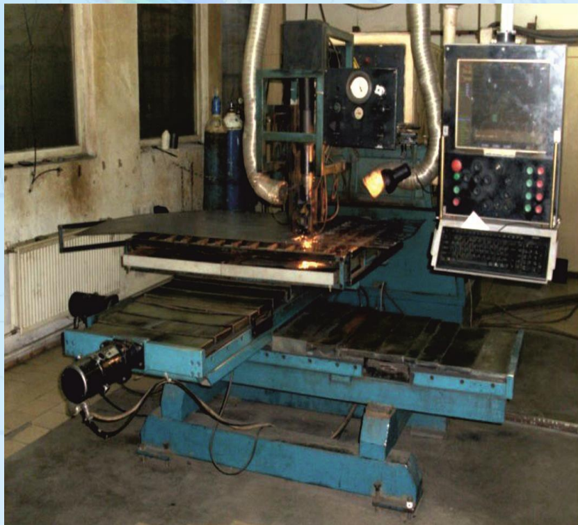
Технологична система за лазерно рязане, базирана на бързопроточен CO 2 лазер
